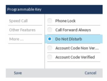
6. With **Do Not Disturb** highlighted, press the **Save** softkey.
